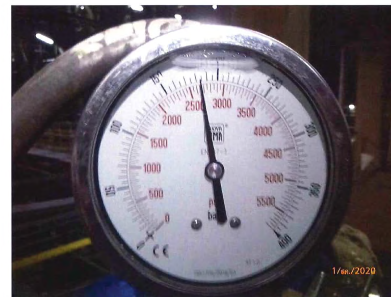
ภาพแสดงแรงดันขณะทำการทดสอบแรงดัน (Low Point)
